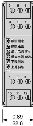
16~30 AWG 导线的螺丝终端
